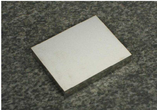
図5 コーティング処理後の金型
