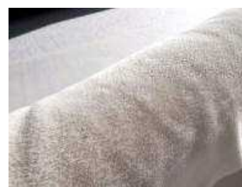
図7 試作したシルク人工毛皮(経編立毛編地)
