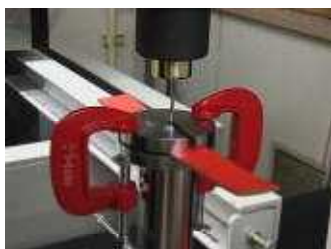
図6 突き刺し抵抗性試験
