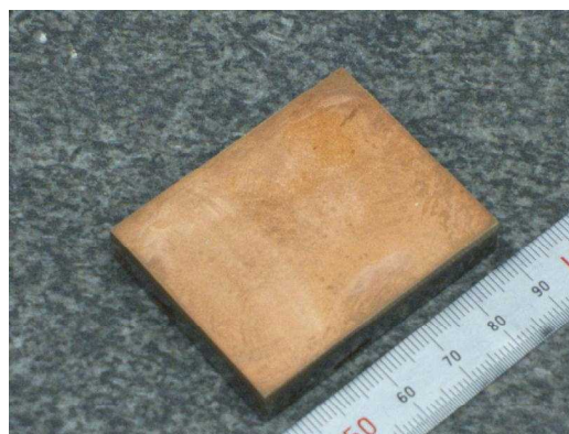
図2 変色した金型(2.4inch)
