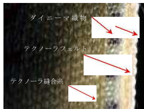
図4 積層織物の構成
