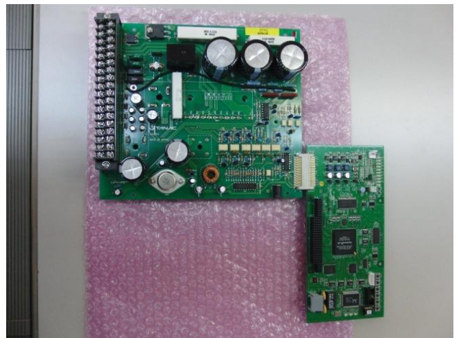
図 15 開発した制御基板、インバータ基板
