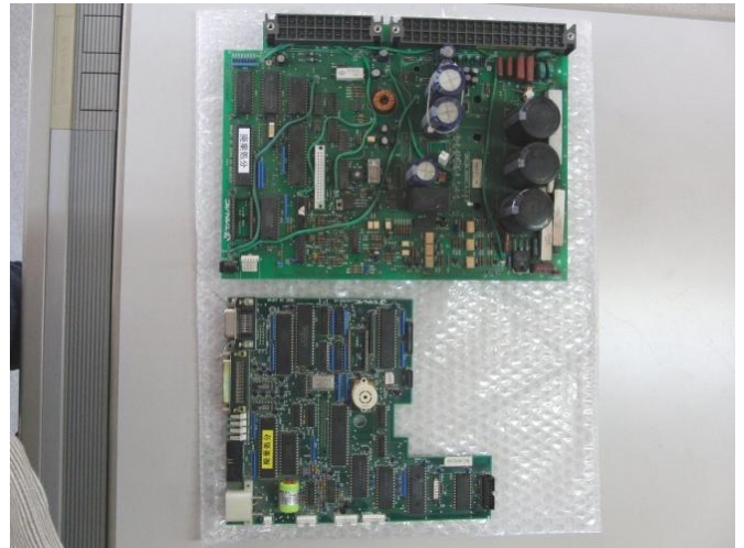
図 14 現行の制御基板、インバータ基板
