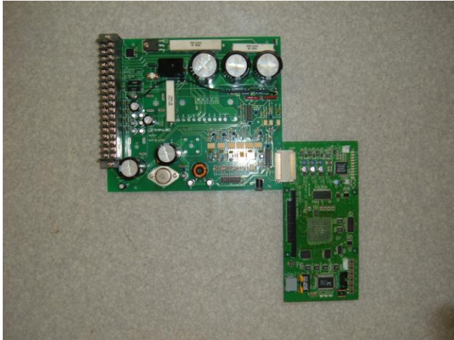
図4 FPGA基板とインバーター基板の接続
