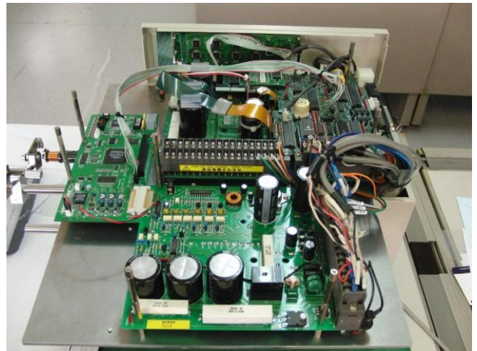
図 17 現行基板と開発基板併設実験（本体後方より）
