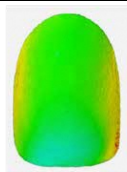
図3 塗装による変形の評価 (X線CTによる比較)
