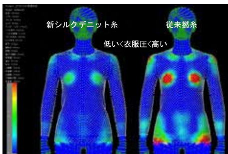
図3 3DCADによる衣服圧のシミュレーション結果
