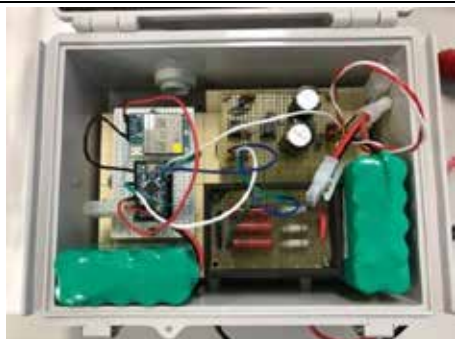
漏電検出・通報装置
