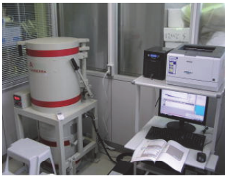
ゲルマニウム半導体検出器型放射能測定装置 (キャンベラ製 GC3020)
