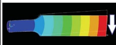
共振時の変形分布 (1次モード 448Hz)
