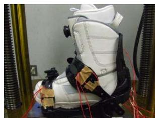
実験によるひずみ測定
