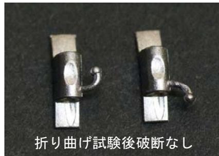
折り曲げ試験後破断なし
