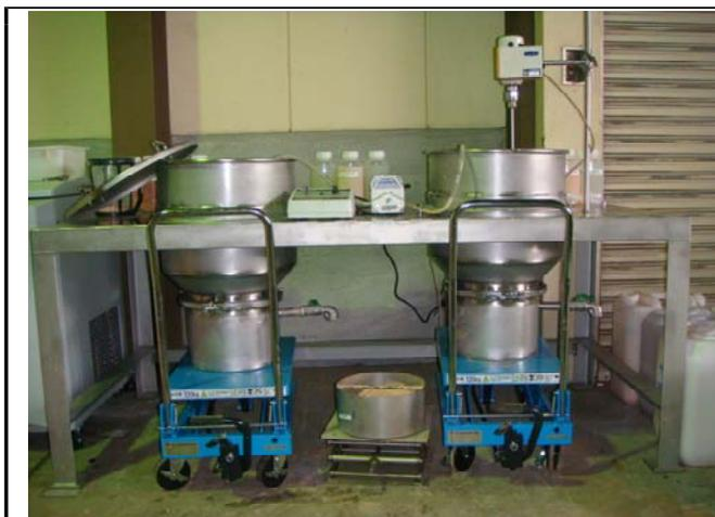
研磨材沈降装置
