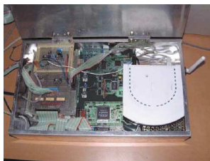
ネットワーク接続された発電システムの制御や計測を行う組み込みマイクロコンピュータの開発と監視・制御用プログラム
