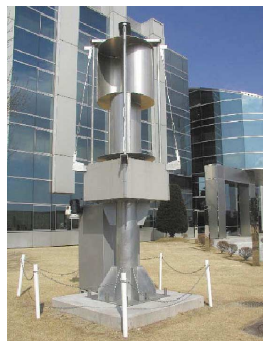
小型風力発電用 サボニウス型風車 羽根の直径 1 m 高さ 2 m
