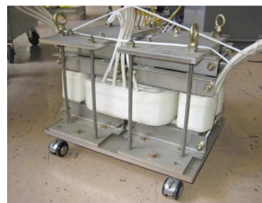
無接点で2次側電圧を可変できる多機能電力調整装置（750VA）
