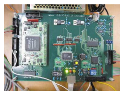
ネットワーク接続された発電システムの制御や計測を行う組み込みマイクロコンピュータの開発と監視・制御用プログラム
