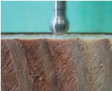
図1 スギ早材部表面硬さの測定方法
