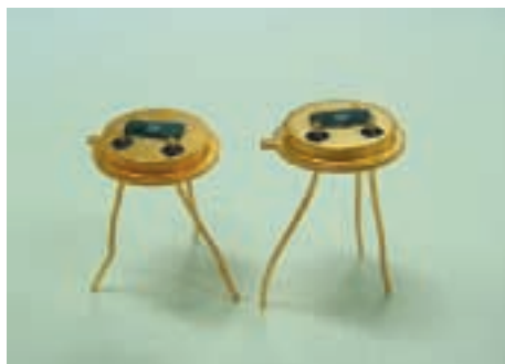
パッケージに実装した赤外線センサー
