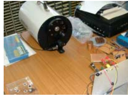
黒体炉を用いて素子の性能を評価しています
