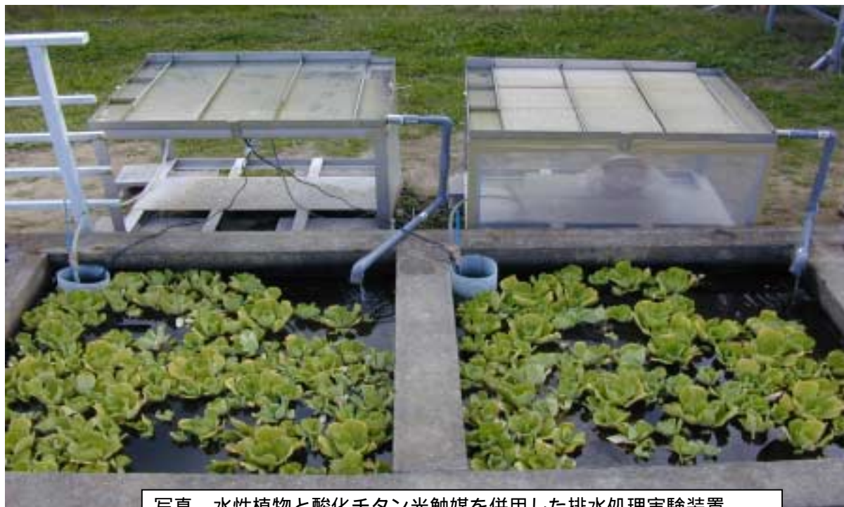
写真 水性植物と酸化チタン光触媒を併用した排水処理実験装置
