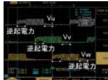
図4 ブラシレスDDCモータの逆起電力を利用したセンサレス制御
