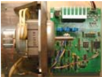
図3 埋込磁石シンクロナスモータと電流センサを用いたモータドライブ回路
