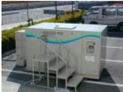
実証試験用発酵槽
