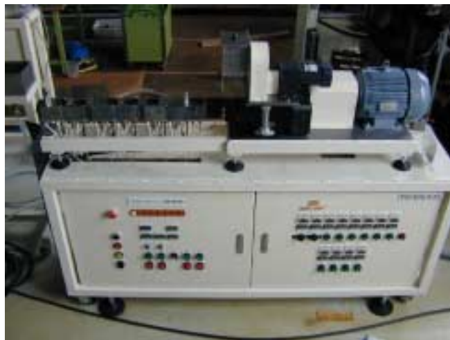
同方向完全噛合型二軸混練押出機（L/D 45）
