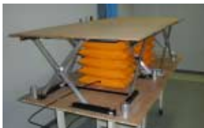
図6-10 ジャバラタイプを用いた昇降機構部
