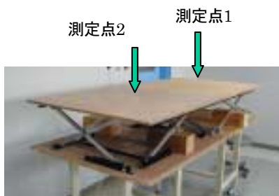
図6-6 ベッド上面の変位測定点
