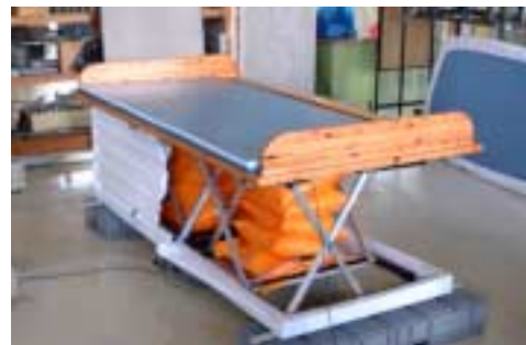
図13 昇降機構部に木部を設置
