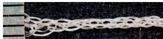
図10 緯糸用リリヤーン糸(加工後織度:560[D]) (PET+熱融着糸)
