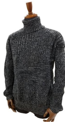
図7 改質リネン横編地の試作品 (7[G]リンクス柄ホールガーメント、重量:360[g])
