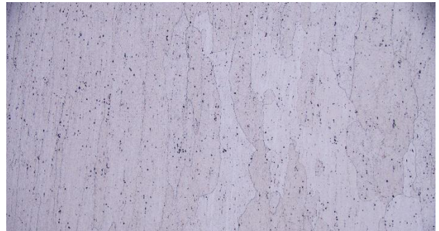
図11 11-4 熱処理後組織観察結果
