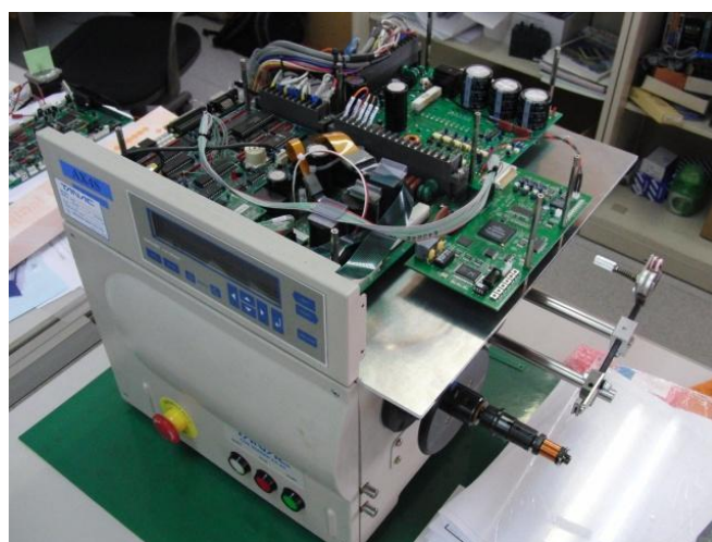
図 18 現行基板と開発基板併設実験（スピンドル、トラバース側より）
