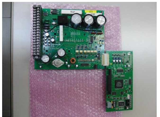
図 15 開発した制御基板、インバータ基板
