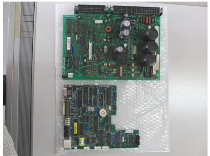
図 14 現行の制御基板、インバータ基板
