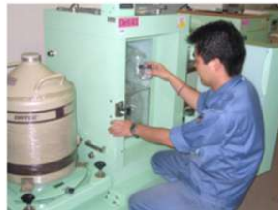
ゲルマニウム半導体検出器 (写真:(財)日本分析センターホームページより)
