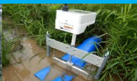
自動水門による水管理
