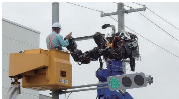
▲ 搬入機一体の型重機。JR西日本及び日本信号㈱と合同で「空間重作業人機」開発プロジェクトを推進
