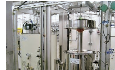
▲水素の熱的特性を測定する装置
