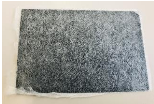
図3 和紙と樹脂で成形した 平板形状の立体模様 (W74×D50×H3 mm)
