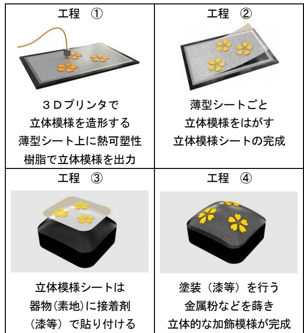
図2 立体模様シートの工程
