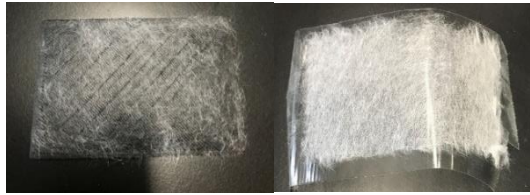
図6 左：和紙の繊維が付着した樹脂面 右：はがした薄型シート
