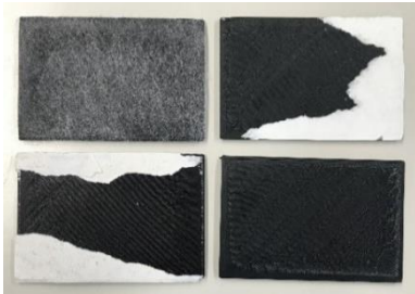
図7 薄型シートをはがした樹脂面 左上：和紙 右上：コピー用紙 左下：厚紙 右下：トレッシングペーパー
