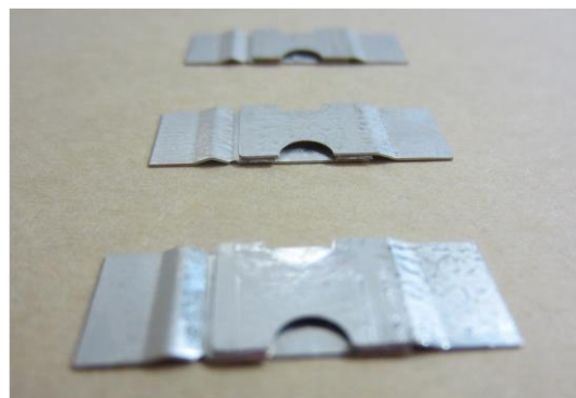
図7 ばね構造付きバイパスダイオード
