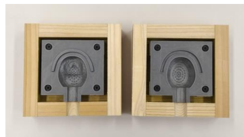
図6 改良した量産用型と木製外枠
