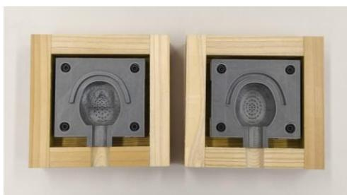
図6 改良した量産用型と木製外枠
