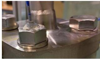
図3 ボルトへの熱電対の取付状況
