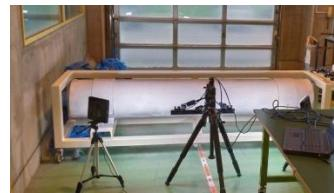
図7 蓄圧器模擬モデルのDIC測定試験状況
