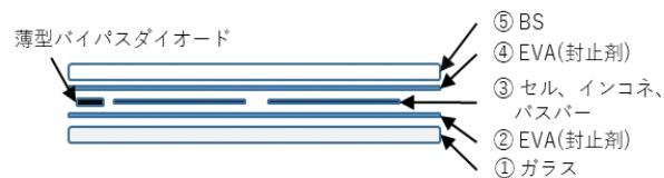
図18 ミニモジュールの断面図
