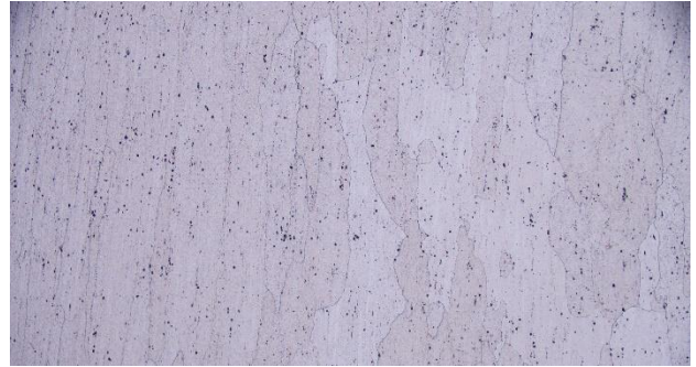
図11 11-4 熱処理後組織観察結果
