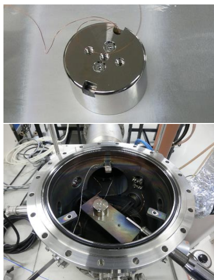
図1 実験に用いた真空部材 （上：真空部材，下：チャンバー内の設置状況）
