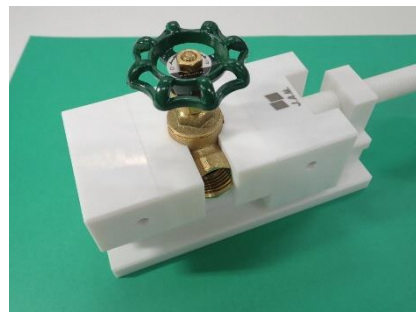
開発した手法による配管用バルブの把持
