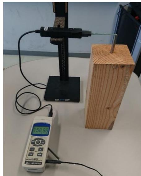
図8 円柱アルニコ磁石の磁束密度測定
