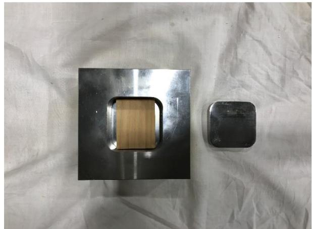
図1 3 成形型へ素材を投入
