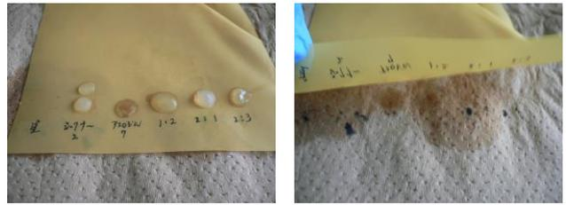
図6 スクリーン上の保持実験結果
