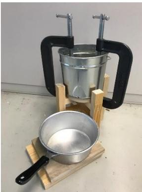
図11 簡易の圧搾器
