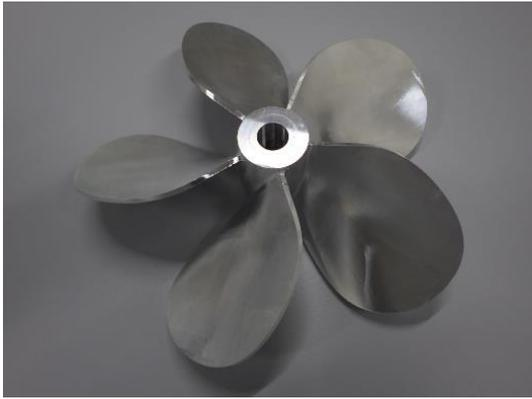
図5 プロセスAにより作製したスクリュープロペラ形状
