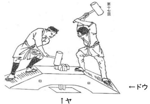
図1 伝統工法でろうを搾る 伝統道具のドウとヤ
