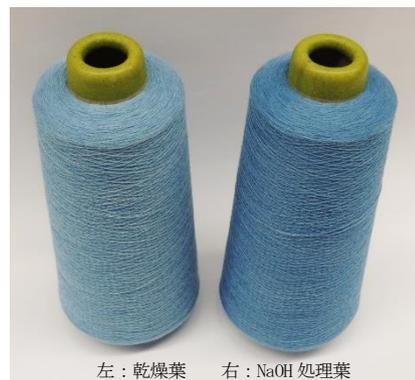
図4 化学建てにより染色した綿糸
