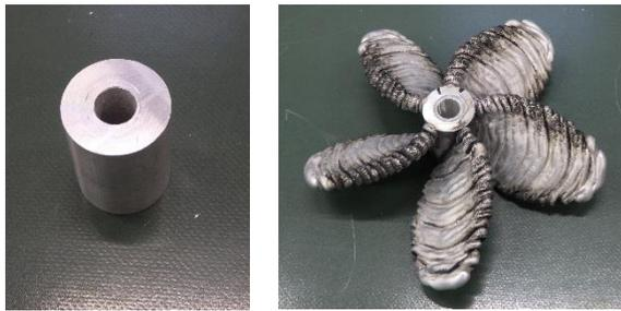
(a) 積層造形前 (b) 積層造形後
