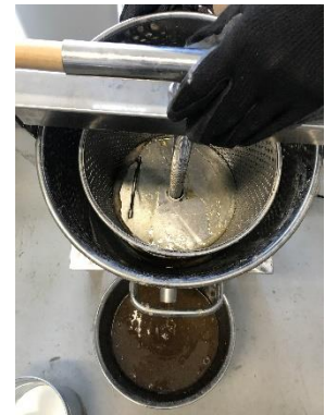
図16 圧搾天板にもろうは冷えて付着するため湯で鍋に流す
