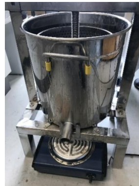
図15 電気コンロを設置した市販の圧搾器
