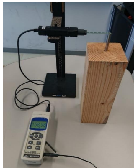
図8 円柱アルニコ磁石の磁束密度測定
