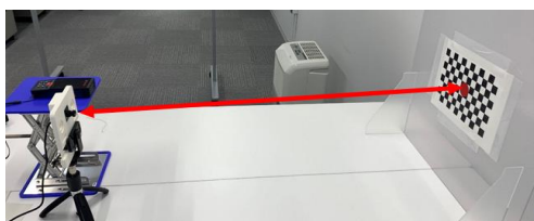
図3 カメラからチェックボードまでの距離
