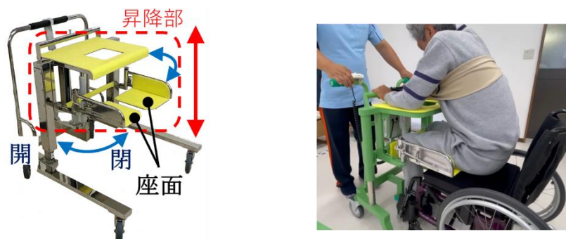
図1 移乗用機械「移乗です」 アクチュエータ部の耐久試験をしたい！
