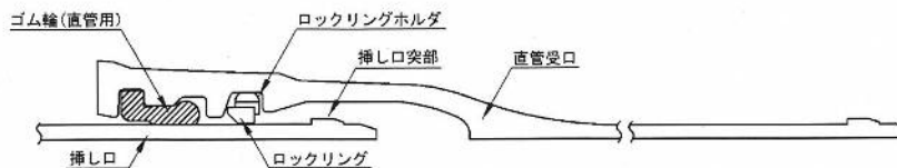
図-3.2.10 GX形直管(呼び径 75~400)
