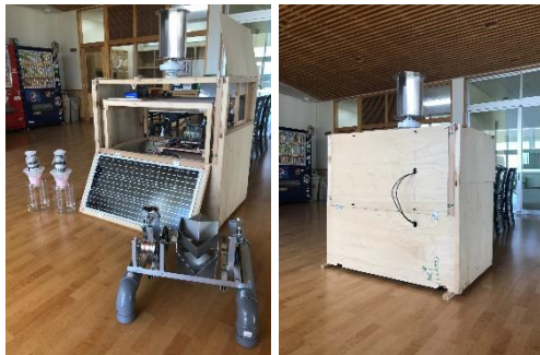
勿来工業高校 5学科共同で災害時に役に立つシス テム「災害派遣用発電装置 勿工 くん」を制作。太陽光や風力、水力の 力を利用してバッテリーに充電、災害 時に電気を使用可能 また、災害時に河川水を利用し、 飲料水確保するろ過装置を製作
