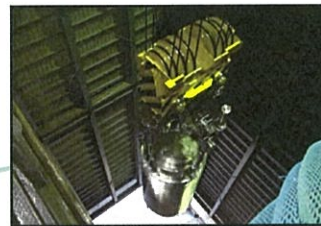
⑤キャスクの吊り降ろし (撮影日:平成25年11月21日)
