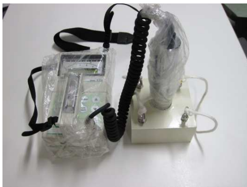
図-23 鉛コリメータに検出器を差した状態のサーベイメータ
