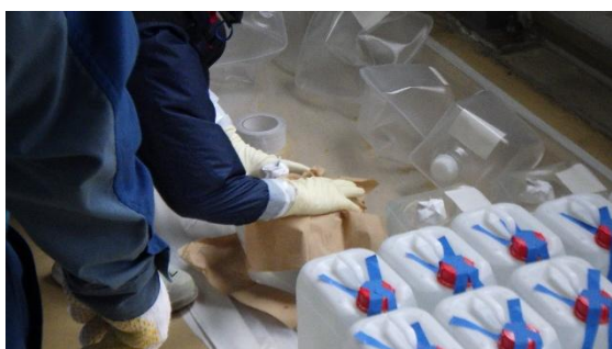
(写真 8－1) サンプリング後の試料容器の拭きあげ作業の状況
