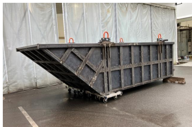
構内運搬容器（ベッセル等）
