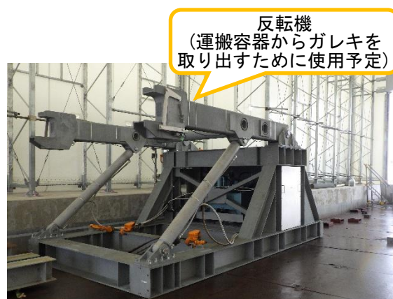
（写真4）小割テントにおける反転機の搬入状況
