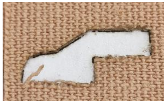
図2 テーピングテープの加工結果
