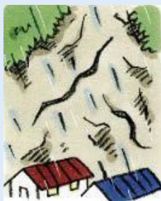
①斜面に亀裂
