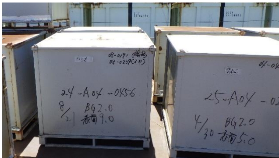
(写真 5 - 2) ガレキ類が入れたコンテナ (コンテナに表面線量率が記載)
