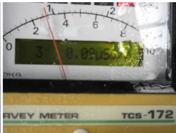
(写真4) 輸送物の表面線量率の測定値 (表示値: 0.09 \mu\text{Sv/h} )
