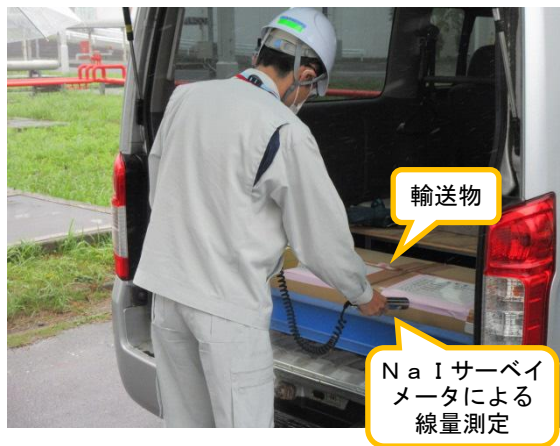
(写真3) 県職員による輸送物の表面線量率の測定状況
