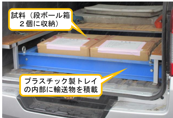
(写真1) 原子炉格納容器内部から採取した試料の輸送車両への積載状況 (固縛実施前)
