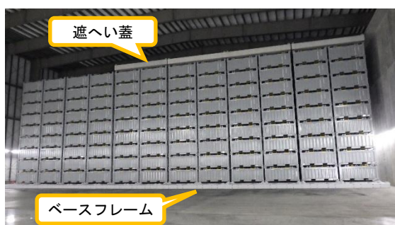
(写真1①) A棟におけるコンテナの保管
