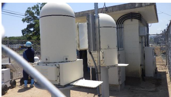
(写真3-4) モニタリングポスト (No. 2) の状況 (検出器)
