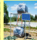
日射制御型自動かん水システム
