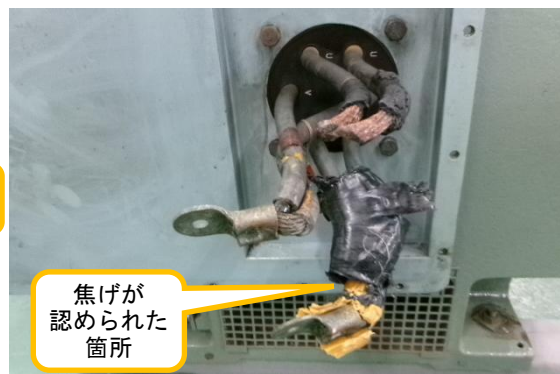
(写真6) RCW2ポンプ（A系）のモータの端子部（写真5拡大図）
