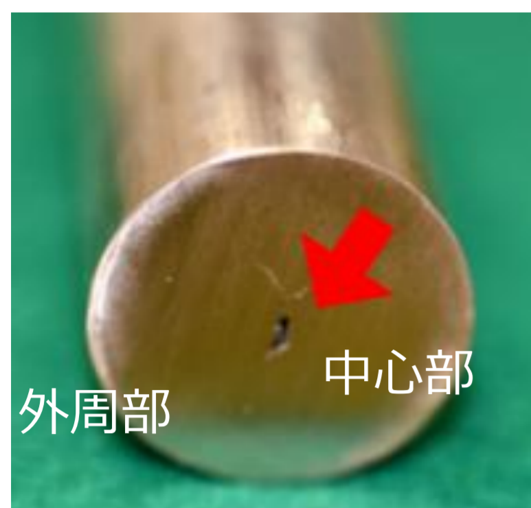
図1 中心部の割れ
