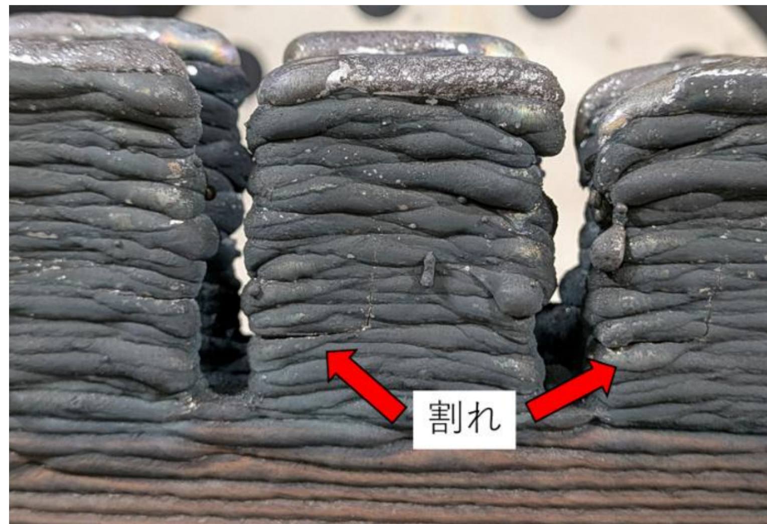
図1 割れの発生したコバルト基合金積層造形部
