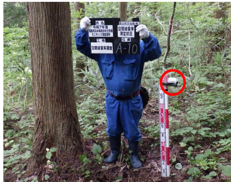
空間線量率の測定状況
