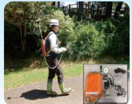
例：歩行サーベイによる空間線量の測定
